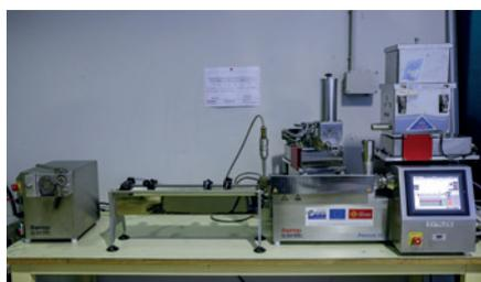
Mise en œuvre des biocomposites par extrusion double vis à l'échelle laboratoire (0,5 kg/h)
