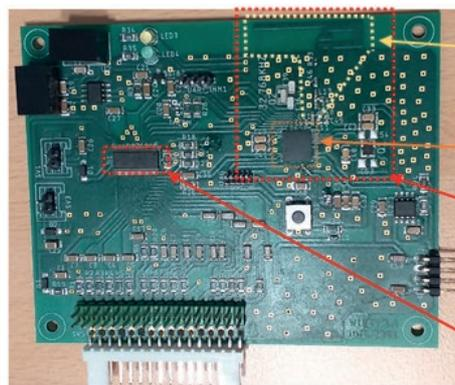
L'antenne 2.4Ghz et le circuit d'antenne.
